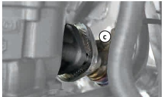
Der Krümmer-Querschnitt kann durch die Verwendung eines Drosselplättchens reduziert werden.
